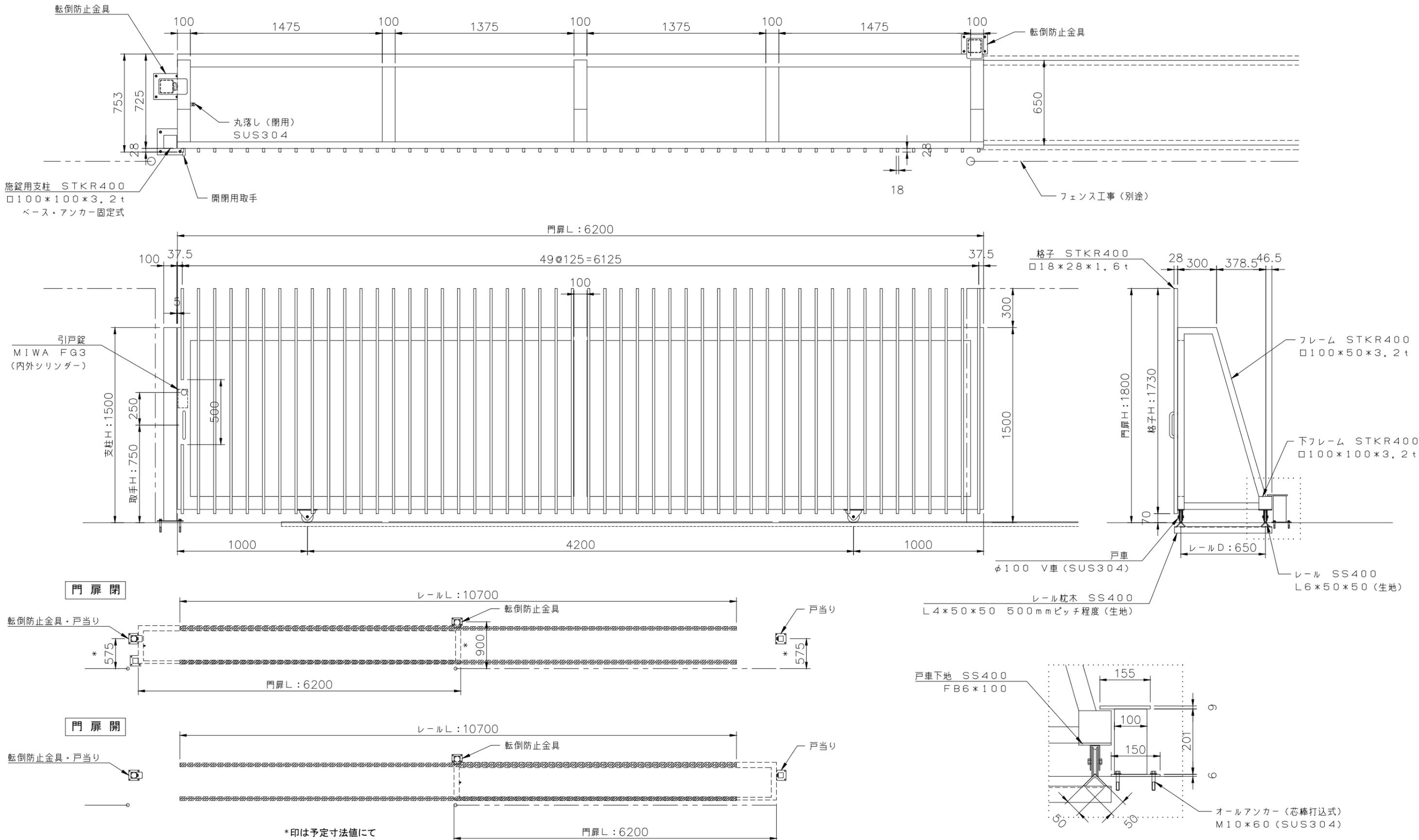
\*\*\*表記なき場合エポキシ樹脂系サビ止・ウレタン樹脂系仕上げ塗装(共に1液)塗装加工品とする。
